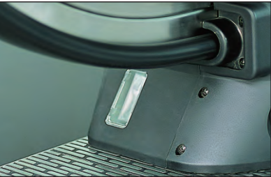
S型及F型自动扶梯的3D感应装置
